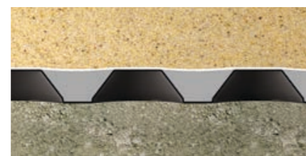
Поведение геотекстиля Тураг, скрепленного с выступами дренажного ядра
